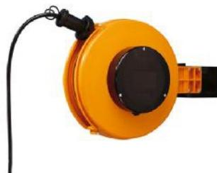
Защита от перегрузок посредством плавкой вставки на 10А. Тип кабеля: H05VV-F. В комплекте: универсальное настенно-потолочное крепление и замок размотки кабеля с функцией отключения.
