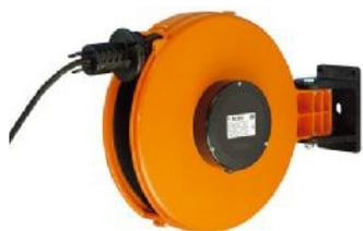
Прочный кабельный барабан с кольцевым токосъемником. Защита от перегрузок посредством плавкой вставки на 10А. Поворотное настенное крепление (потолочное крепление как опция) и замок размотки кабеля с функцией отключения. Тип кабеля: H07RN-F. Без штекера.
