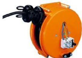
Предназначен для безопасной подачи энергии и защиты кабеля. Монтируется на стену, потолок и т.д. Защита от перегрузок посредством плавкой вставки на 10А. Модели EFT 160/160А и выше оснащены клеммной крышкой.
